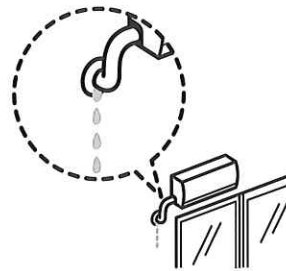
エアコンの水漏れ
