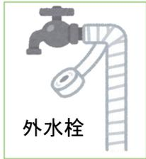
屋外の水道管・水道メーターボックスに、保温材・毛布・タオル等を巻きつけておく。
