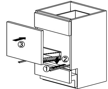
ソフトクローズレールはゆっくり自動的に閉まる機構が付いていますが、収納重量によってその動作は変化します。また、閉める力が強すぎると勢いよく閉ることがあり、弱すぎると途中で止まることがありますが、故障ではありません。収納重量に応じて適度な強さで閉めてください。
