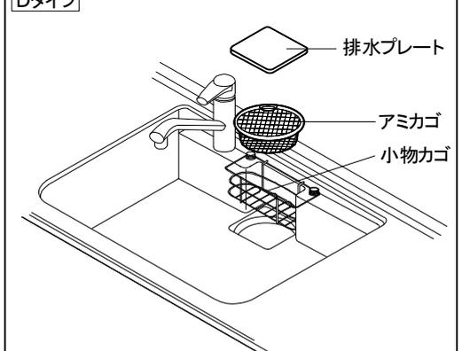
※シンク内に水を溜める場合は、排水プレートははずしてオプション部品の水どめふたを使用する。
