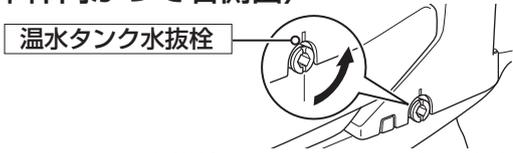
※温水タンク水抜栓は、温水タンク内の水を抜くときに外します。(☞ 33 ページ)
